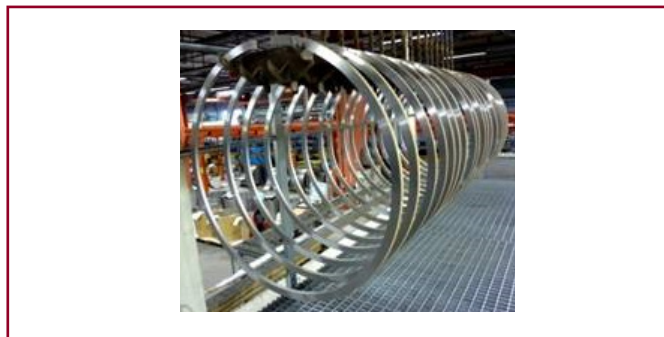
大型活塞环和气缸套 用于船用和固定电/动力发动机
