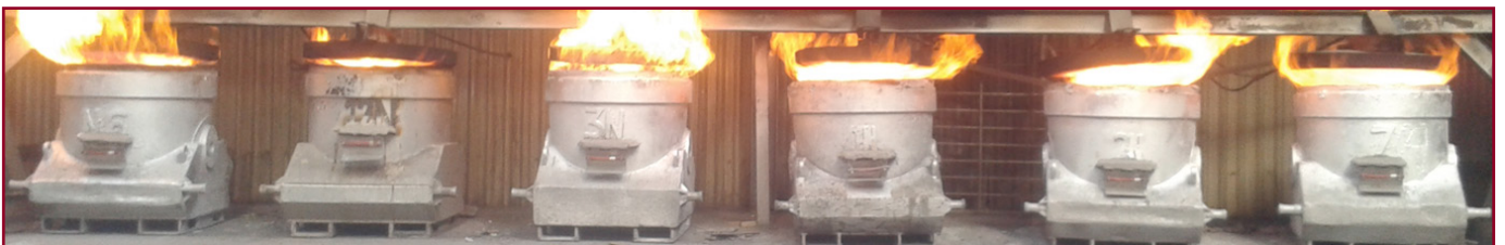
图6: RFID标签或2D光学矩阵板可以使浇包在整个工艺过程被跟踪, 把每个铸型和铁水联系起来。
