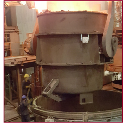
图3: 可以使用RFID标签或2D光学矩阵板(图示)来识别浇包。
