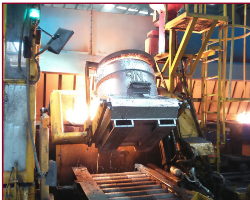
그림 1: 래들추적기술 및 제품추적기술은 코어와 금형이력을 용탕이력과 연결시켜 완벽한 추적성을 제공합니다
