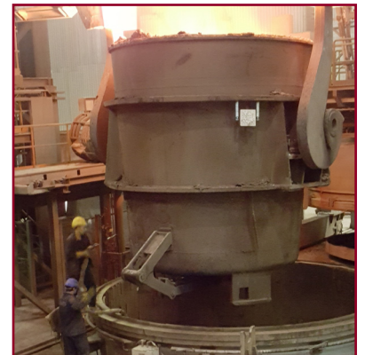
그림 3: RFID 태그 또는 2D 매트릭스 판으로 각각의 래들을 확인 할 수 있다
