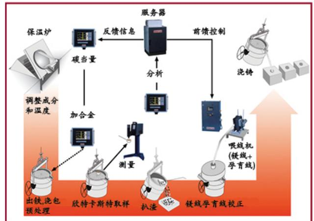
图1: 浇铸包生产的工艺控制
